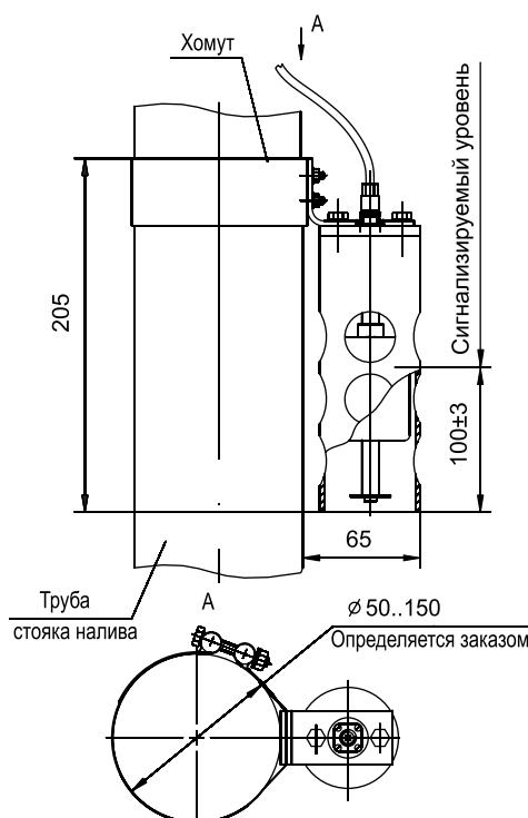
1. **Выходной сигнал** – магнитоуправляемый замыкающий герконовый контакт с рабочими параметрами: 0,2А; 50 В; 10 Вт.
