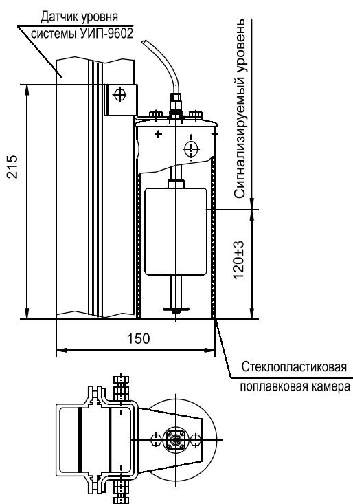
1. **Выходной сигнал** – магнитоуправляемый замыкающий герконовый контакт с рабочими параметрами: 0,2A; 50В; 10 Вт.
