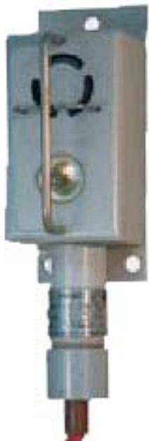
Предназначен для подачи звуковых и световых сигналов во взрывоопасных зонах «В-1а» и «В-1г» в условиях открытой атмосферы. Имеет маркировку взрывозащиты 1ExdsIIIT3. В качестве источника звука используется пьезоизлучатель, источника света – светодиодные индикаторы высокой яркости с широким углом обзора.
