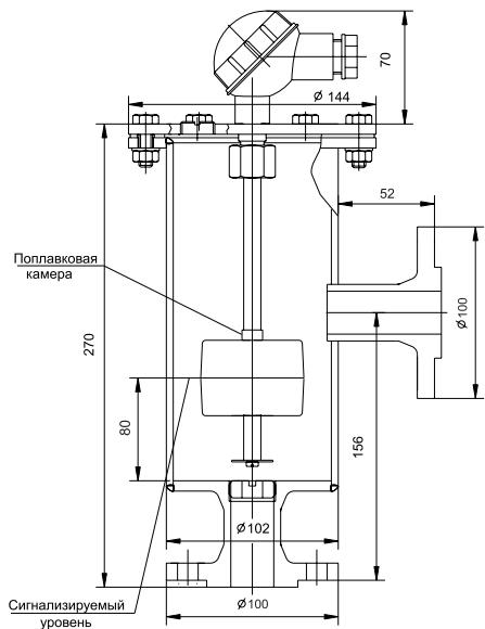
1. **Выходной сигнал** – магнитоуправляемый замыкающий герконовый контакт с параметрами: 0,2А; 50В; 10 Вт.
