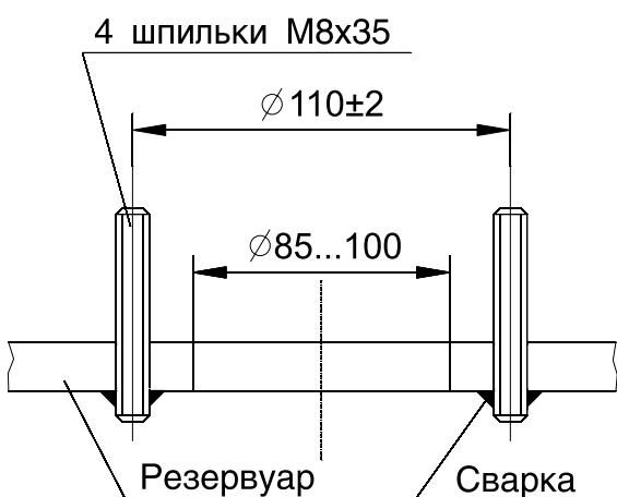
**Рис.4. Посадочное место на резервуаре №2 (используется проставка с ответным фланцем, крепление с помощью 4-х болтов M8x25)**
