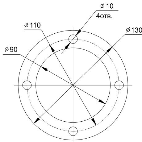
**Рис.3. Посадочное место на резервуаре №1 (без использования проставки и ответного фланца, крепление на 4-е шпильки M8x25)**
