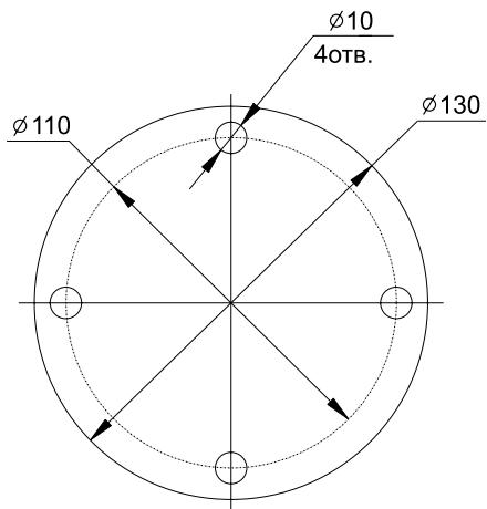
**Рис.2. Размеры ответного фланца к фланцу датчиков ДС100/101/100ПТ**
