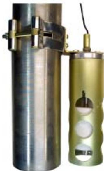
Предназначен для сигнализации предельного уровня нефтепродуктов при заполнении авто- и железнодорожных цистерн с использованием стояков налива. Датчик крепится на стояке налива с помощью хомута из нержавеющей стали. Подключение к системе управления с помощью кабеля с разъемным соединением на датчике.
