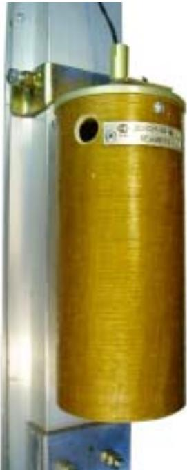
Датчик предназначен для контроля максимального уровня нефтепродуктов в резервуарах хранения.
